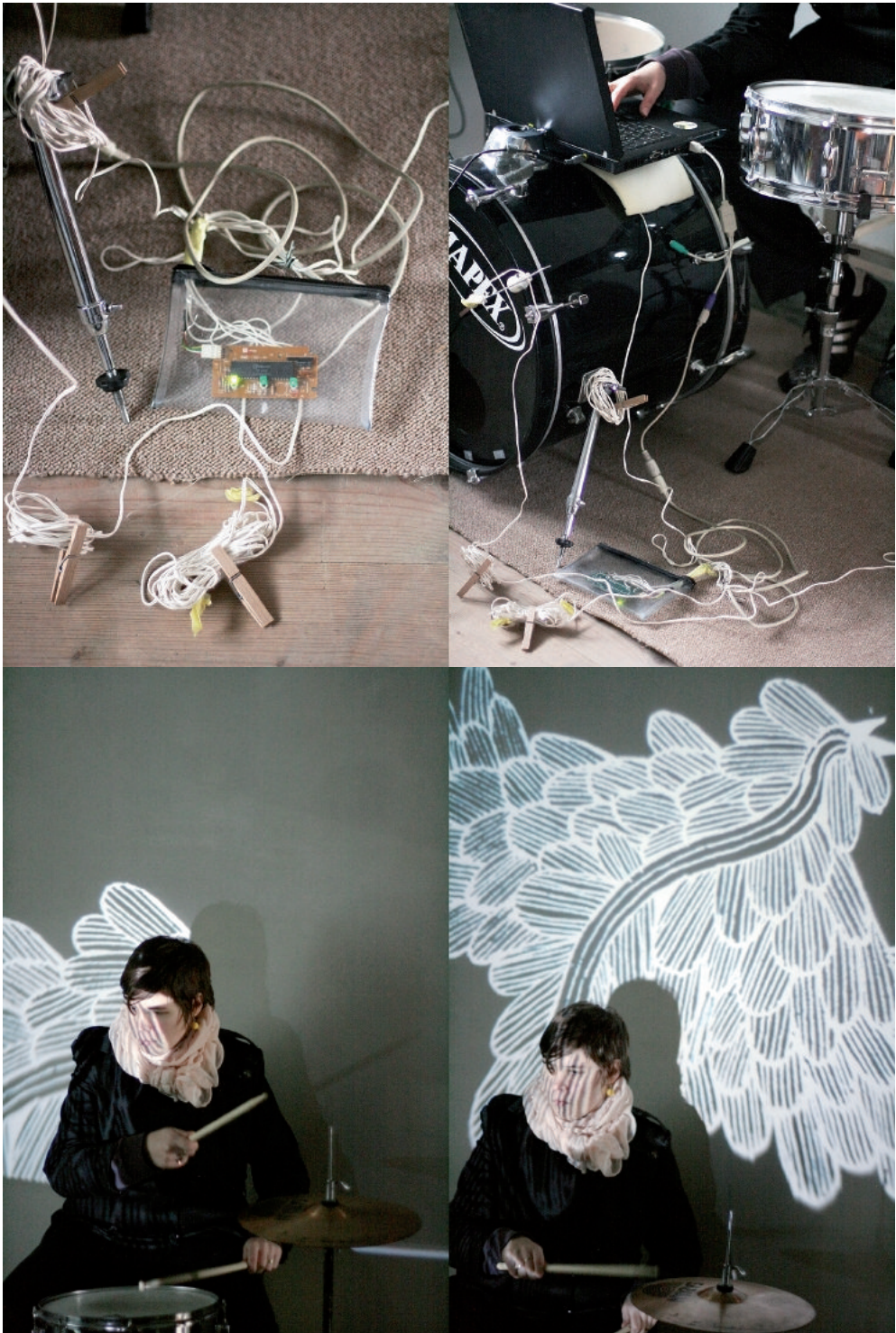
BEATA ZDRAŽILOVÁ, AUTORSKÝ AUDIOVIZUÁLNY NÁSTROJ PRE HUDOBNÚ SKUPINU BAS. POMOCOU AUTORSKÉHO HARDVÉRU INŠTALOVANÉHO DO BICÍCH SPŮŠŤALA ALEBO MANIPULOVALA VLASTNÉ ANIMÁCIE PRIAMO POČAS HRANIA, 2009-2010.
