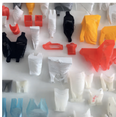
Skúšky foriem pre 3D tlačný luster.
