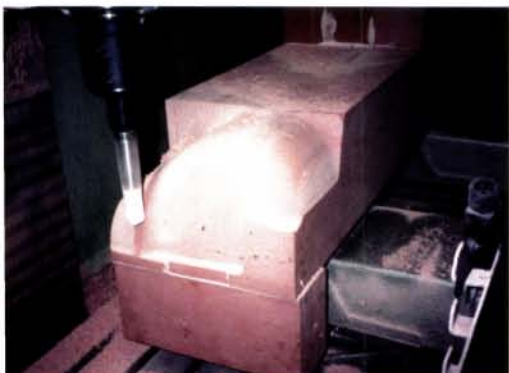
Opracovávanie mastermodelu prístrojovej dosky s využitím CAD a CNC systémov.
