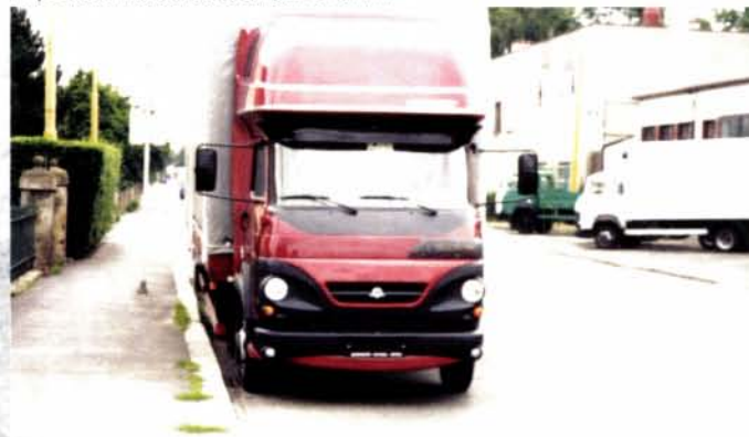
Úprava kabíny vo verzii Wide, ktorá umožňuje aplikovať na podvozok nadstavbu so šírkou 2520 mm.
