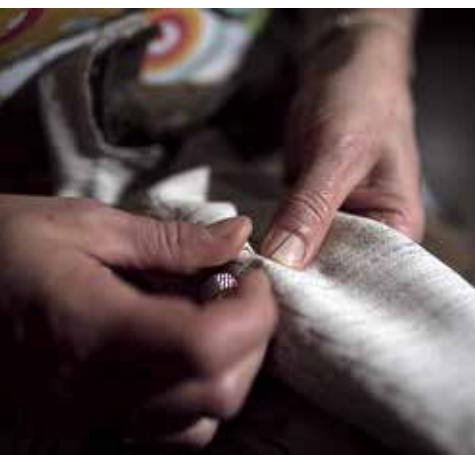
Ručné pikírovanie plátna pre vystuženie predného dielu saka.
