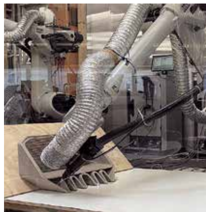
ZUV (Zero-Emission Utility Vehicle). 3D tlač karosérie pomocou robotického ramena.
