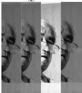
Ukážka prenosu fotografickej predlohy sublimačnou tlačou na polyester pri rôznych nastaveniach parametrov stroja. Z projektu Márie Fulkovej.
