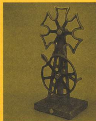
Jednozubový mechanický prevodový systém, 1900-1910.
