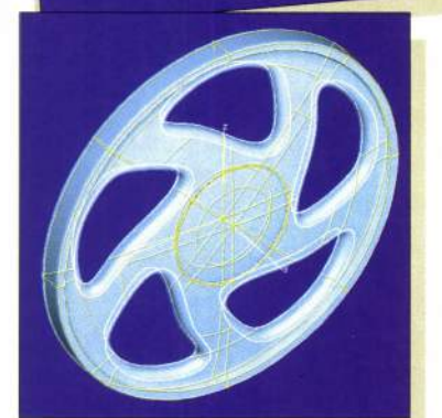
DeskArtes Rapid Tools poskytuje nástroje na manipuláciu s virtuálnymi modelmi ešte pred spustením výroby stereolitografického modelu.
