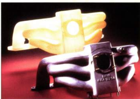
Stereolitografický model sacieho potrubia automobilu BMW - pred a po úprave
