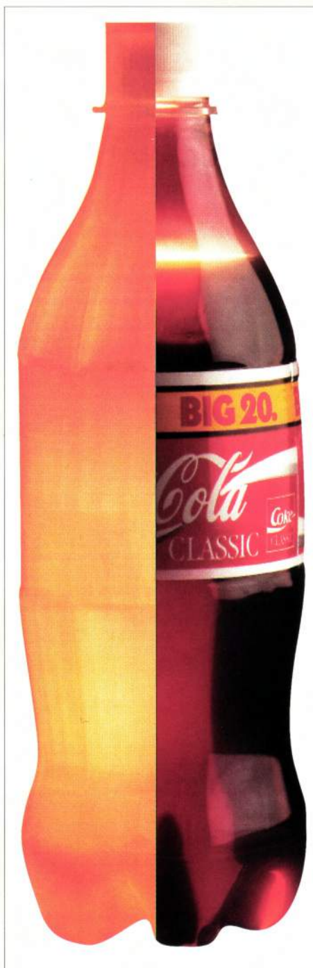
Stereolitografický model a výrobok.
