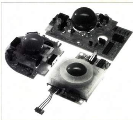
Polohovacie zariadenie k počítaču firmy Logitech (vnútorné vybavenie a vonkajšia podoba)
