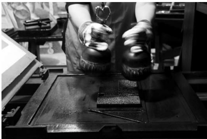
Kožené tampóny, ktorými sa nanášala farba na sadzbu.
