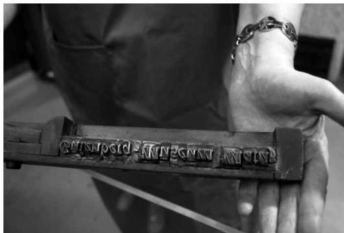
Riadok textu Gutenbergovho písma B 42 v sádzadle.
