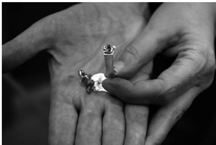
Kuželka písma odliata z Gutenbergovej matrice.
