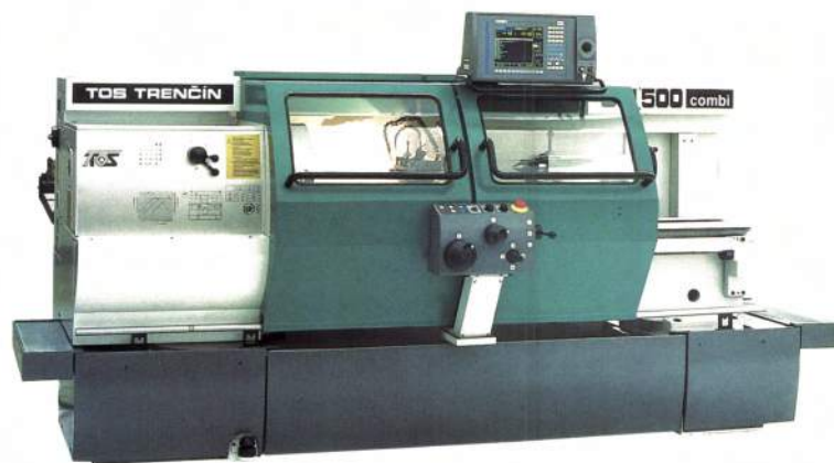
Hrotový poliautomatizovaný sústruh SUI 500 COMBI Dizajn: Vladimír Pavlík Výrobca: TOS Trenčín, a. s.
