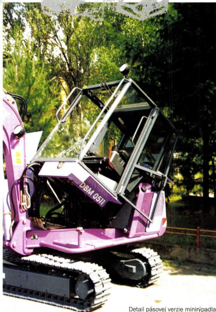
Detail pásovej verzie minirýpadla so zdvihnutou kabinou.
