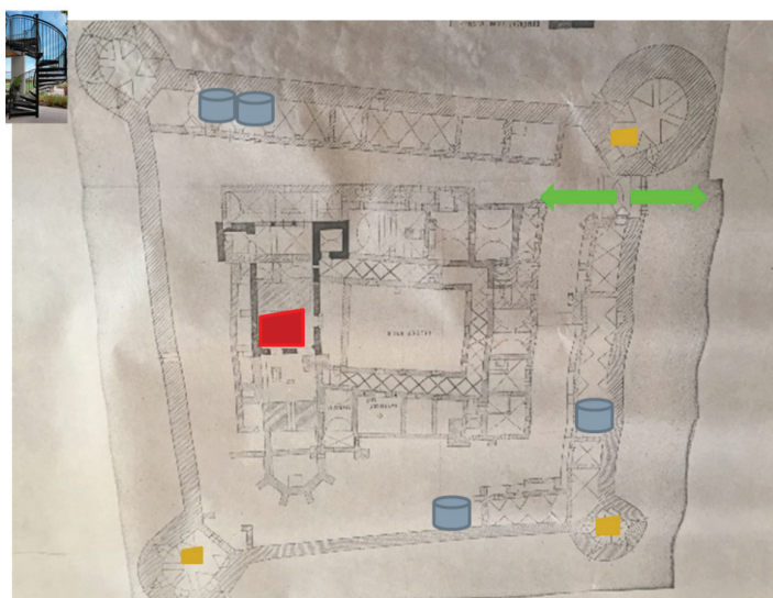
Obrázok 48 Prezentácia základných opatrení na vybavenie pre požiarnu bezpečnosť hradu Bzovík na pôdoryse hradu, ktorý je uložený na Obecnom úrade Bzovík.
